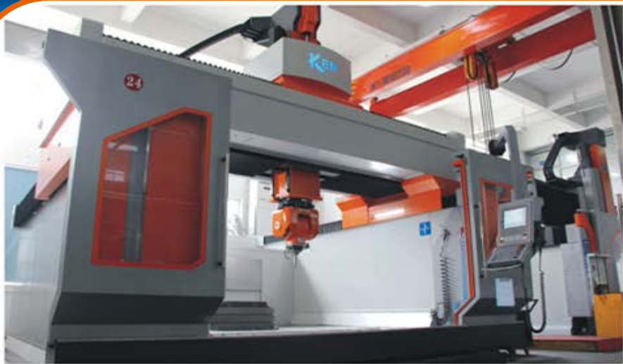
大前五轴加工中心TCH-19(A63) :1台 5-sedid&5-axis TCH-19(A63) CNC Machining: 1sets 主要参数Major Parameters:2500x1500x1000mm
