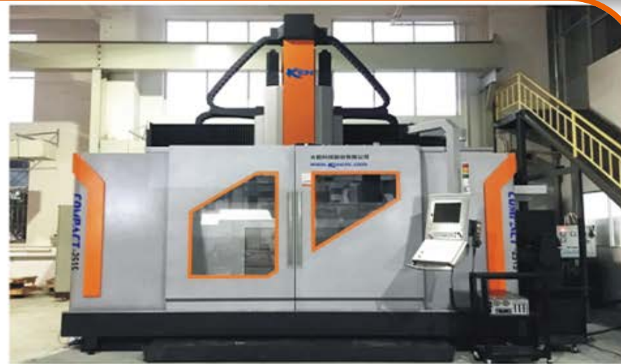
大前五轴加工中心TCH-19(A63) :1台 5-sedid&5-axis TCH-19(A63) CNC Machining: 1sets 主要参数Major Parameters:3200x2200x1250mm
